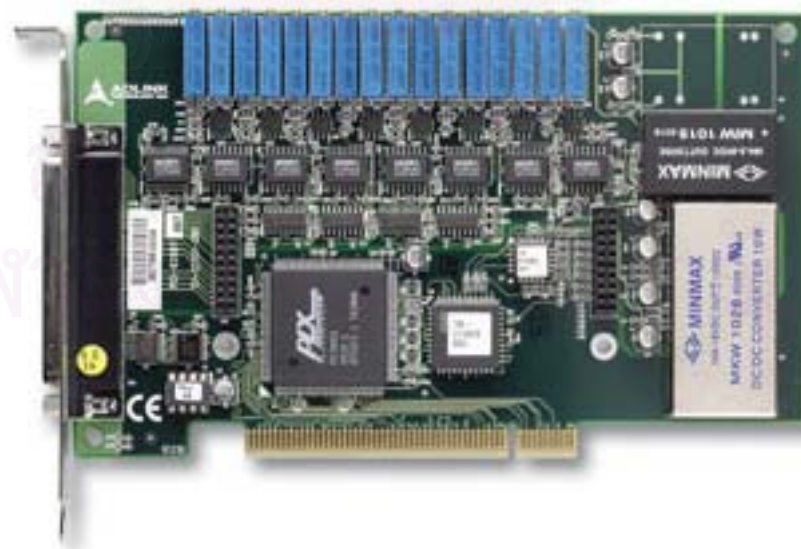
รูปที่ ก.4 แสดงการ์ดแปลงสัญญาณจากดิจิทัลไปเป็นอนาลอก
