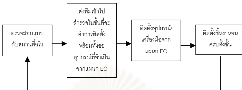
แผนภาพที่ 1.8 แสดงขั้นตอนการทำงานของฝ่ายก่อสร้าง
