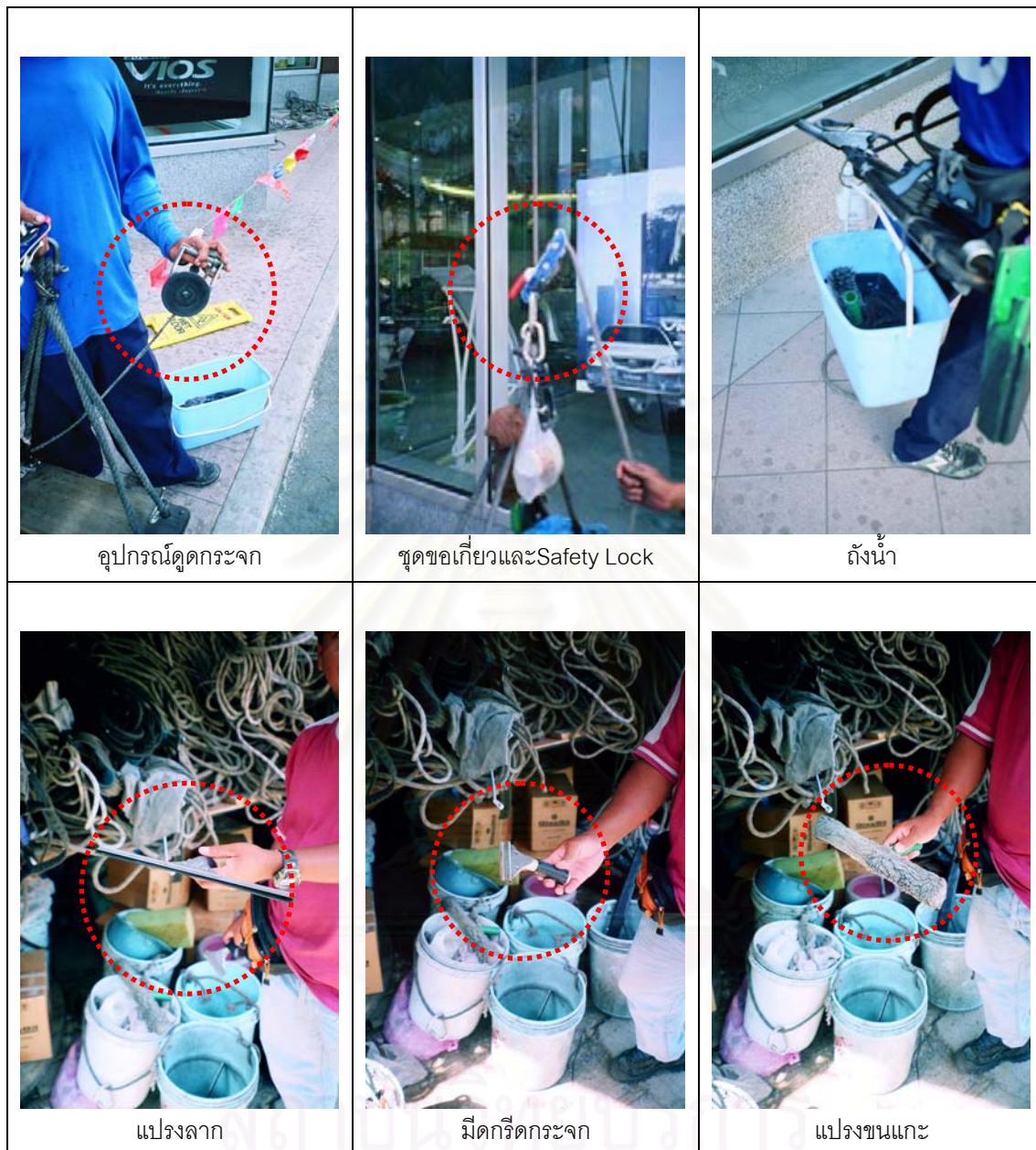
รูปภาพ 2-5 แสดงอุปกรณ์ในการโรยตัวและอุปกรณ์ทำความสะอาดของ Spiderman
