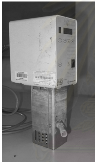
รูปที่ 2.27 อุปกรณ์สำหรับการเปรียบเทียบ Thermocouple วัดอุณหภูมิ
