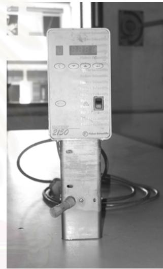
รูปที่ 2.27 อุปกรณ์สำหรับการเปรียบเทียบ Thermocouple วัดอุณหภูมิ
