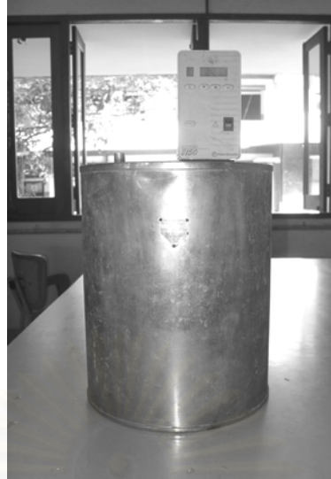
รูปที่ 2.27 อุปกรณ์สำหรับการเปรียบเทียบ Thermocouple วัดอุณหภูมิ
