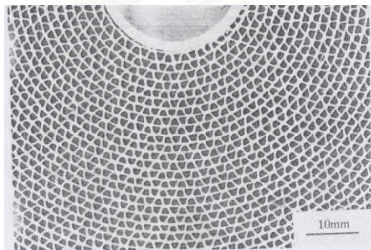
รูปที่ 3.1 ลักษณะภาคตัดขวางของท่อภายในโรเตอร์
