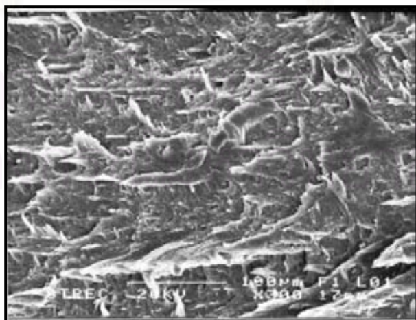
รูปที่ 4.20 สัณฐานวิทยาของพอลิไวไนลคลอไรด์ผสม MBS (สารเสริมทนแรงกระแทกที่ใช้ในเชิงพาณิชย์) ที่อัตราส่วน (ก) 5 phr (ข) 10 phr (ค) 15 phr (x 300)
