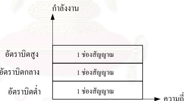
รูปที่ 1.6 การส่งสัญญาณโดยใช้วิธีที่ใช้อัตราชีพคงที่เชิงความถี่
