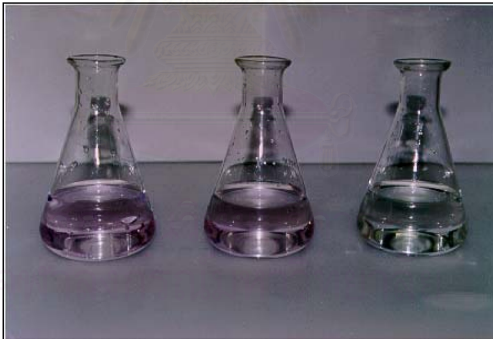
รูปที่ 4.10 เปรียบเทียบประสิทธิภาพในการใช้ Q-R กาบมะพร้าว กำจัดสีรีแอกทีฟที่ความเข้มข้น 200 , 150 และ 90 มิลลิกรัม/ลิตร จากขวาไปซ้าย (ประสิทธิภาพ 98.76 –100%)
