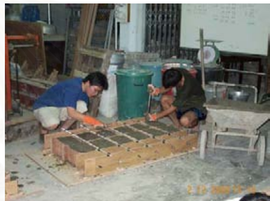
รูปที่ ข-8 ภาพการแต่งและฉาบผิวตัวอย่างที่ใช้ในการทดสอบกำลังยึดเหนี่ยวระหว่างคอนกรีตกับเหล็กเสริม
