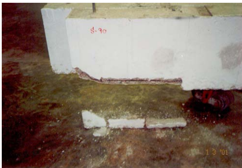
รูปที่ ก-36 ภาพถ่ายแสดงความเสียหายของคานตัวอย่างที่ศึกษาพฤติกรรมการรับแรงเฉือนที่ผ่านการเผาไฟ 90 นาที จนไม่อาจทำการทดสอบได้
