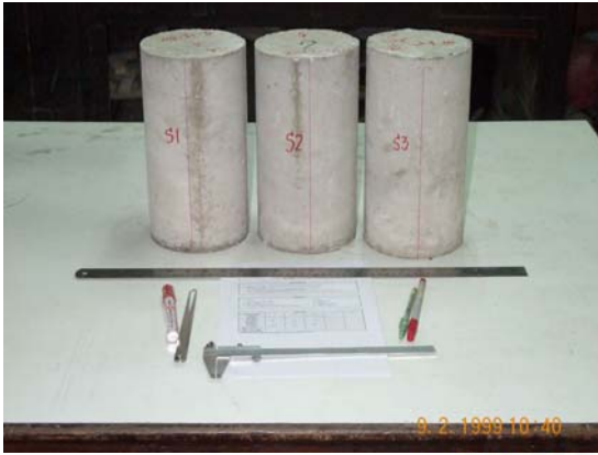
รูปที่ ค-4 ภาพการทดสอบค่ากำลังรับแรงดึงแบบ splitting test คอนกรีตตามมาตรฐาน ASTM C496 (ซ้าย-แท่งตัวอย่างที่ใช้ในการทดสอบ, ขวา-การกดแท่งตัวอย่าง)
