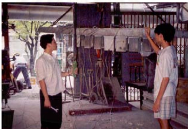
รูปที่ ค-13 ภาพการติดตั้งตัวอย่างเข้ากับแผ่นพื้นฝ้าเตาสำหรับการทดสอบกรณีศึกษาที่ 1
