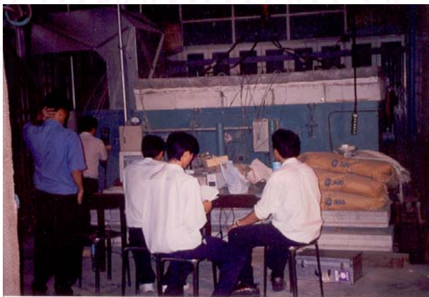
รูปที่ ค-14 ภาพการเผาตัวอย่างและวัดอุณหภูมิในขณะที่เผาด้วยเครื่องคอมพิวเตอร์
