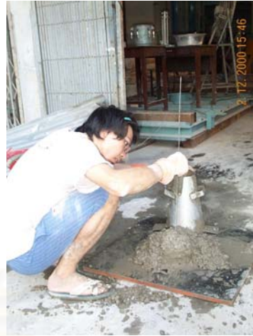
รูปที่ ค-1 ภาพการทดสอบค่าการยุบตัวของคอนกรีตสดตามมาตรฐาน ASTM C143 (ซ้าย-การตึงโคน, ขวา-การอ่านค่าการยุบตัว)
