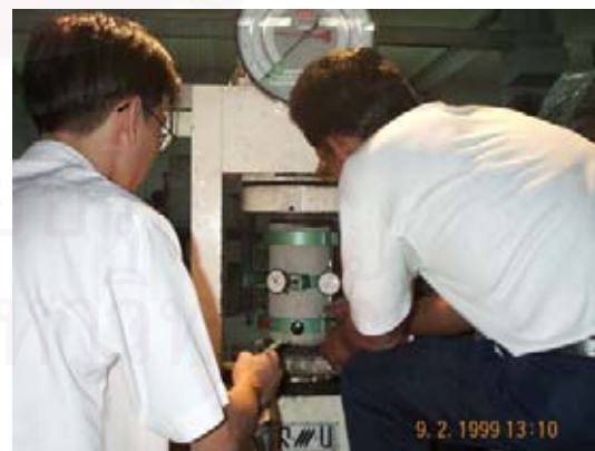
รูปที่ ค-6 ภาพการทดสอบค่าโมดูลัสยืดหยุ่นของคอนกรีตตามมาตรฐาน ASTM C469 (ซ้าย-แท่งตัวอย่างที่ใช้ในการทดสอบ, ขวา-การกดแท่งตัวอย่าง)
