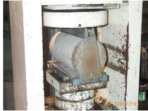
รูปที่ ค-4 ภาพการทดสอบค่ากำลังรับแรงดึงแบบ splitting test คอนกรีตตามมาตรฐาน ASTM C496 (ซ้าย-แท่งตัวอย่างที่ใช้ในการทดสอบ, ขวา-การกดแท่งตัวอย่าง)
