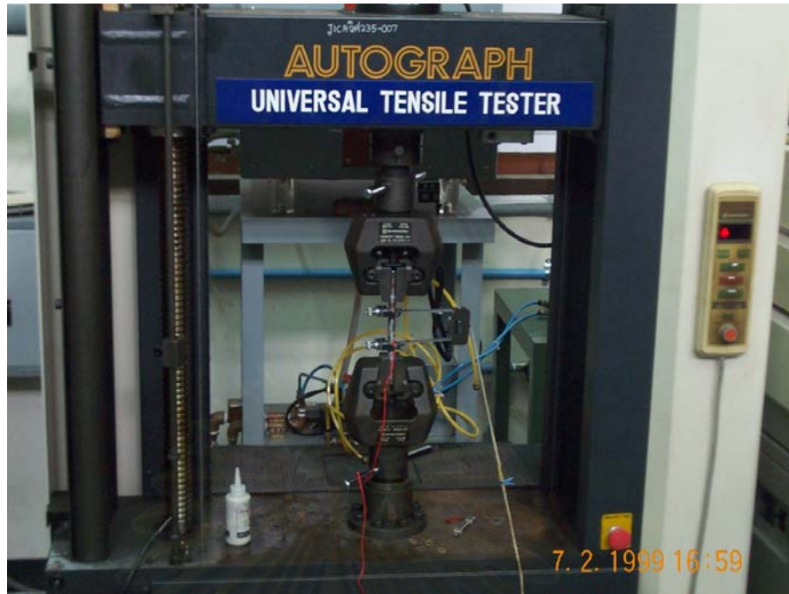
รูปที่ ค-27 ภาพการทดสอบพฤติกรรมของเหล็กเสริมหลังจากถูกเผาไฟตามมาตรฐาน ASTM E8
