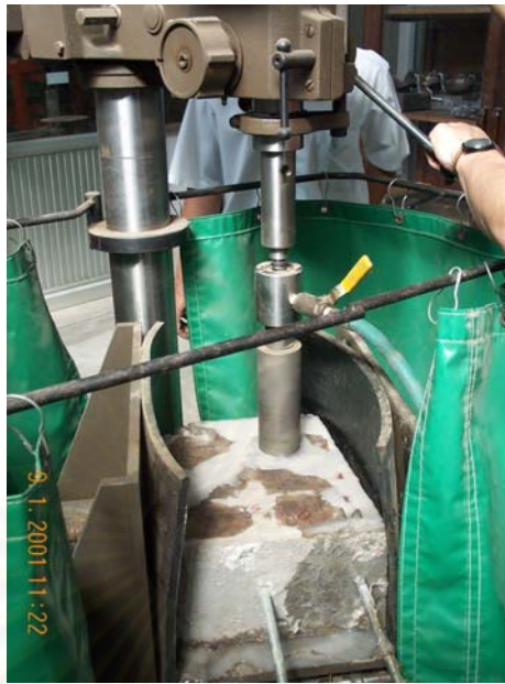
รูปที่ ค-24 ภาพการเจาะลูกคอนกรีตจากตัวอย่างชนิด A และ B ด้วยเครื่องเจาะหิน
