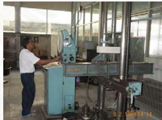
รูปที่ ค-5 ภาพการทดสอบค่ากำลังรับแรงดึงแบบ flexure one point test ตามมาตรฐาน ASTM C293 (ซ้าย-แท่งตัวอย่างที่ใช้ในการทดสอบ, ขวา-การกดแท่งตัวอย่าง)
