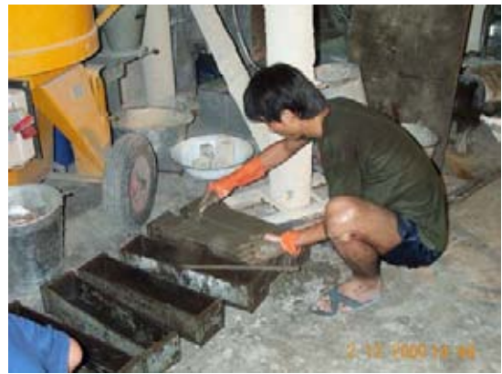
รูปที่ ข-6 ภาพการเก็บตัวอย่างแท่งคอนกรีตขนาด 10x10x50 ซม.
