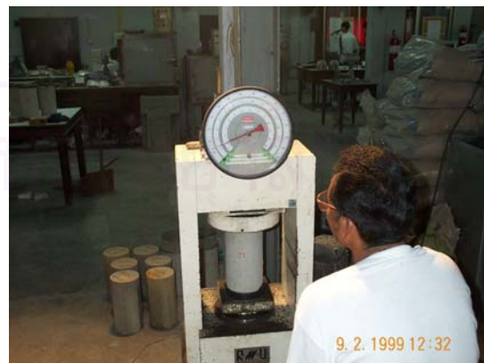
รูปที่ ค-3 ภาพการทดสอบค่ากำลังอัดของคอนกรีตตามมาตรฐาน ASTM C39 (ซ้าย-แท่งตัวอย่างที่ใช้ในการทดสอบ, ขวา-การกดแท่งตัวอย่าง)
