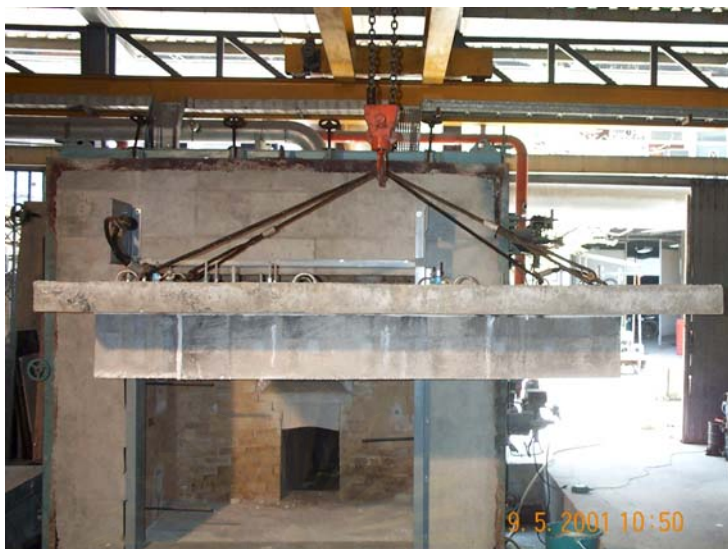
รูปที่ ค-16 ภาพแสดงการติดตั้งตัวอย่างเข้ากับฝาเตาสำหรับการทดสอบกรณีศึกษาที่ 2
