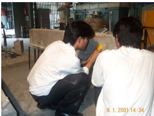
รูปที่ ค-18 ภาพการหาตำแหน่งเหล็กด้วยเครื่อง rebar locator รูปที่ ค-19 ภาพการกำหนดตำแหน่งในการตรวจวัด
