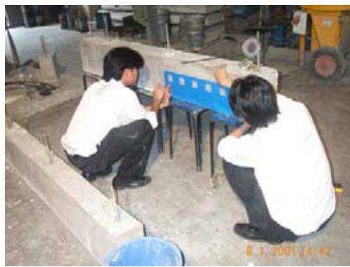
รูปที่ ค-18 ภาพการหาตำแหน่งเหล็กด้วยเครื่อง rebar locator รูปที่ ค-19 ภาพการกำหนดตำแหน่งในการตรวจวัด
