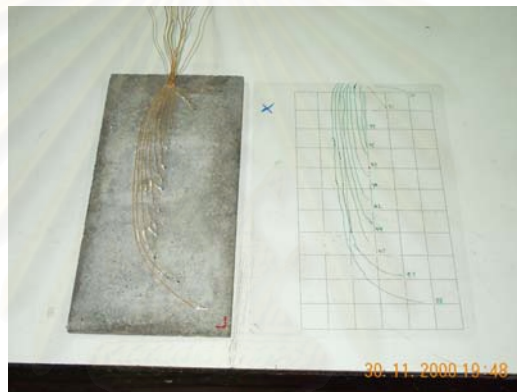
รูปที่ 3-4 แบบตัวอย่างชนิด A ที่ติดสายวัดอุณหภูมิในหน้าตัดขณะเผา
