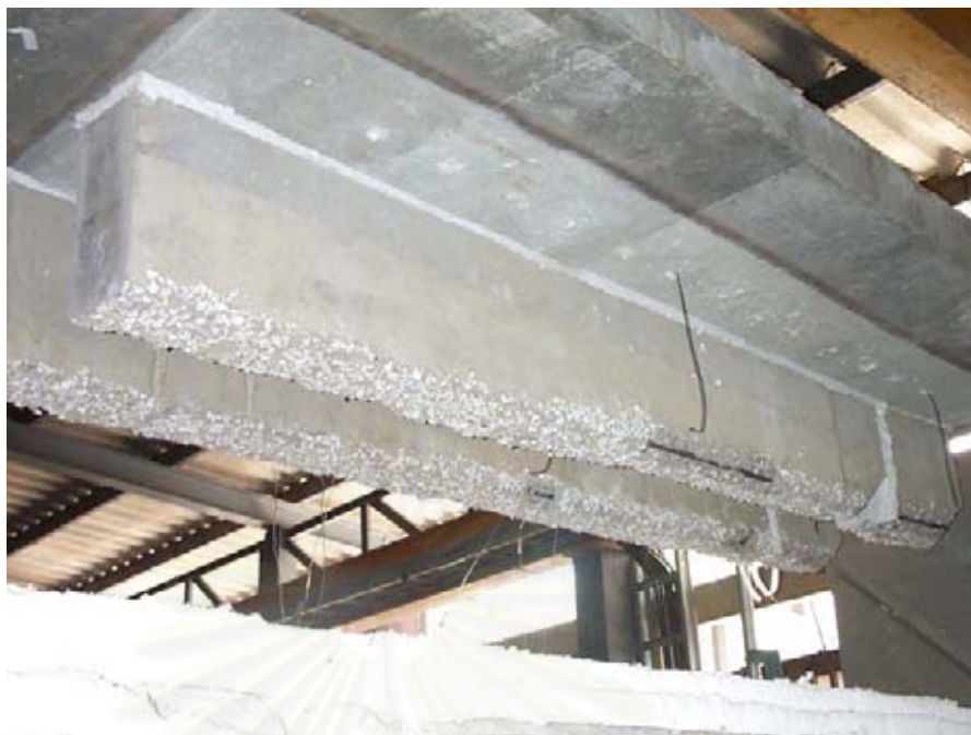
รูปที่ ก-37 ภาพถ่ายแสดงความเสียหายของคานตัวอย่างที่ศึกษาพฤติกรรมการรับแรงเฉือนและแรงดัดที่ผ่านการเผาไฟ 120 นาที จนไม่อาจทำการทดสอบได้
