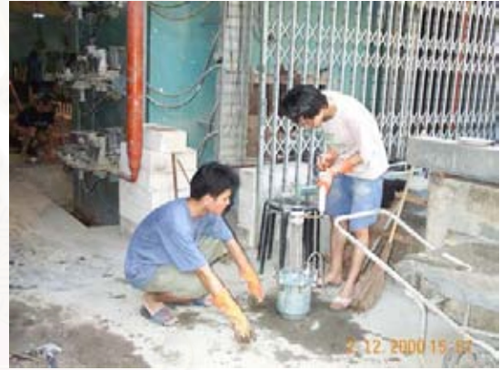
รูปที่ ค-2 ภาพการทดสอบปริมาณฟองอากาศในคอนกรีตสดตามมาตรฐาน ASTM C231 (ซ้าย-การเปิดวาล์วเพื่อใส่น้ำ, ขวา-การอัดอากาศและทำการอ่านค่าระดับน้ำ)
