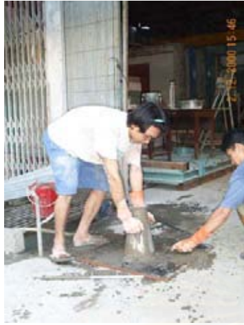
รูปที่ ค-1 ภาพการทดสอบค่าการยุบตัวของคอนกรีตสดตามมาตรฐาน ASTM C143 (ซ้าย-การตึงโคน, ขวา-การอ่านค่าการยุบตัว)
