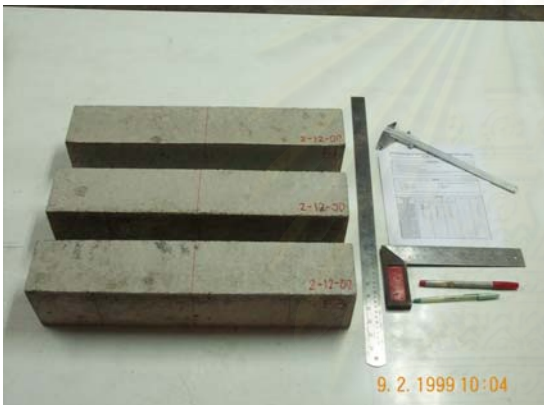
รูปที่ ค-5 ภาพการทดสอบค่ากำลังรับแรงดึงแบบ flexure one point test ตามมาตรฐาน ASTM C293 (ซ้าย-แท่งตัวอย่างที่ใช้ในการทดสอบ, ขวา-การกดแท่งตัวอย่าง)
