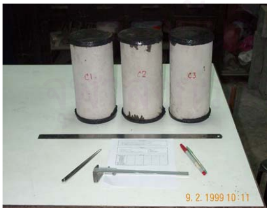
รูปที่ ค-3 ภาพการทดสอบค่ากำลังอัดของคอนกรีตตามมาตรฐาน ASTM C39 (ซ้าย-แท่งตัวอย่างที่ใช้ในการทดสอบ, ขวา-การกดแท่งตัวอย่าง)
