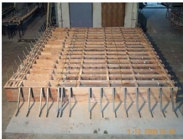
รูปที่ ข-2 ตัวอย่างแบบไม้ที่ใช้ในการเตรียมตัวอย่างที่ใช้ในการศึกษาผลของการเผาไฟที่มีต่อพฤติกรรมของคานคอนกรีตเสริมเหล็ก(กรณีศึกษาที่ 2)
