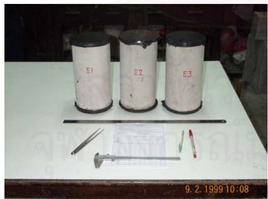
รูปที่ ค-6 ภาพการทดสอบค่าโมดูลัสยืดหยุ่นของคอนกรีตตามมาตรฐาน ASTM C469 (ซ้าย-แท่งตัวอย่างที่ใช้ในการทดสอบ, ขวา-การกดแท่งตัวอย่าง)
