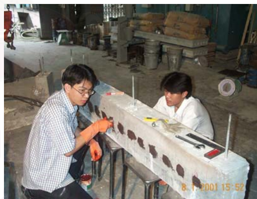
รูปที่ ค-23 การทดสอบด้วยวิธี ultrasonic pulse velocity
