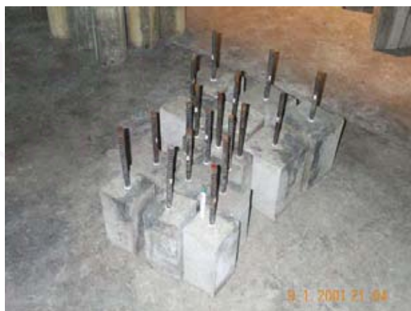
รูปที่ ค-11 ภาพการทำเครื่องหมาย ณ ตำแหน่งเริ่มต้นของเหล็กใน คอนกรีตของตัวอย่างการทดสอบกรณีศึกษาที่ 1
