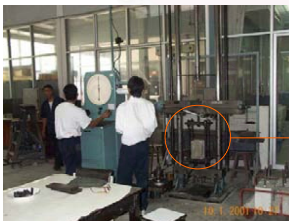
รูปที่ ค-15 ภาพการทดสอบกำลังยึดเหนี่ยวด้วยเครื่อง Amsler universal testing machine 20 tons ของการทดสอบกรณีศึกษาที่ 1
