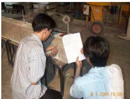
รูปที่ ค-22 การทดสอบด้วยวิธี rebound hammer
