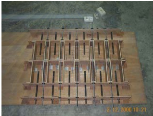
รูปที่ ข-1 ตัวอย่างแบบไม้ที่ใช้ในการเตรียมตัวอย่างที่ใช้ในการศึกษาผลของการเผาไฟที่มีต่อค่ากำลังยึดเหนี่ยวระหว่างคอนกรีตกับเหล็กเสริม(กรณีศึกษาที่ 1)
