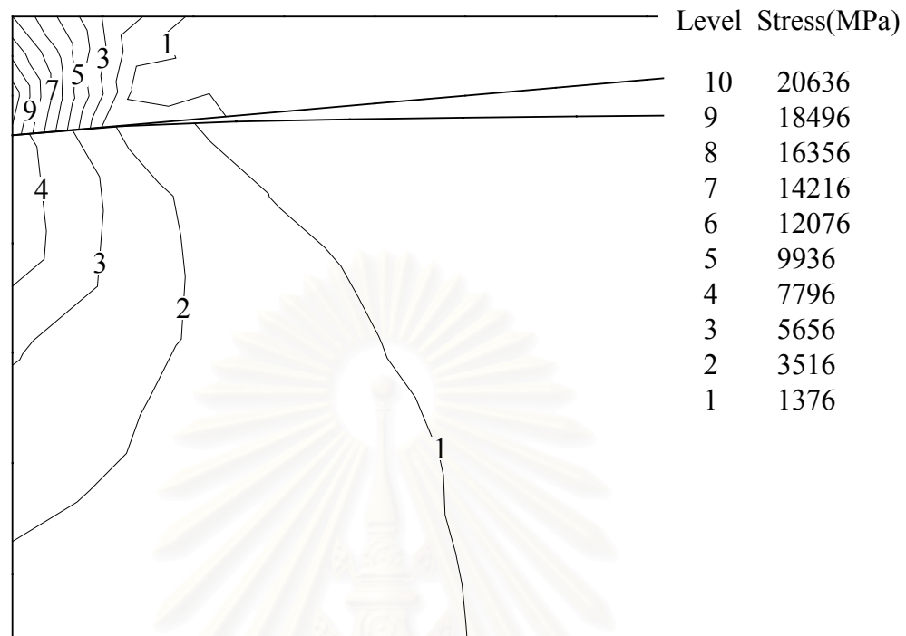
รูปที่ 6.10 รูปร่างของแบบจำลองไฟไนต์เอลิเมนต์เริ่มต้นของปัญหาลิ่มแฉ่งบนพื้นยึดหยุ่น ที่แสดงผลการกระจายค่าความเค้นวอนมิส
