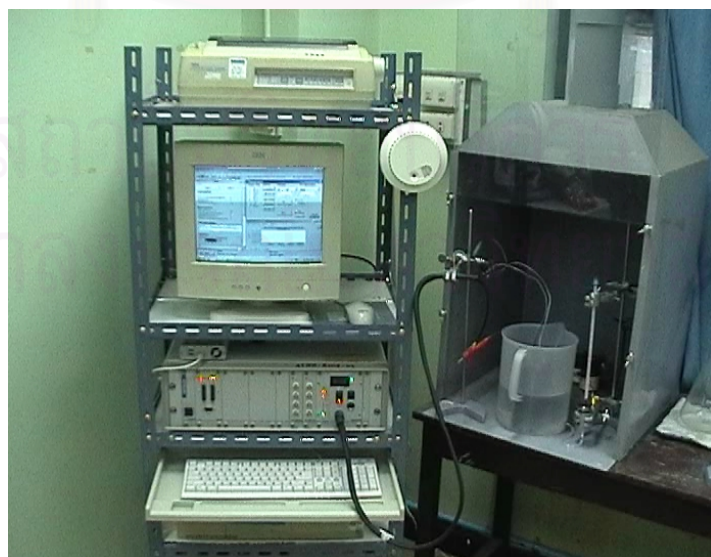
รูปที่ 3.2 เครื่องโพเทนชิโอสแตต ออโตแลป รุ่น PGSTAT20
