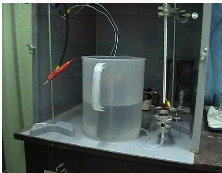
รูปที่ 3.6 ลักษณะเซลล์การกักกร่อนที่ประกอบเข้ากับภาชนะบรรจุน้ำทะเล
