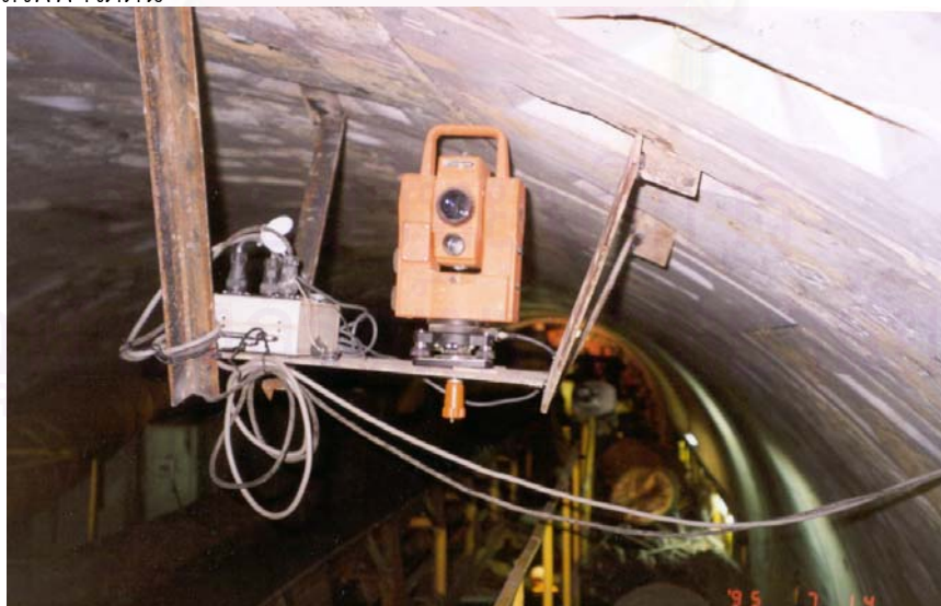
รูปที่ 3.18 แสดงลักษณะกล้องสำรวจวิธี Robotec Survey System
