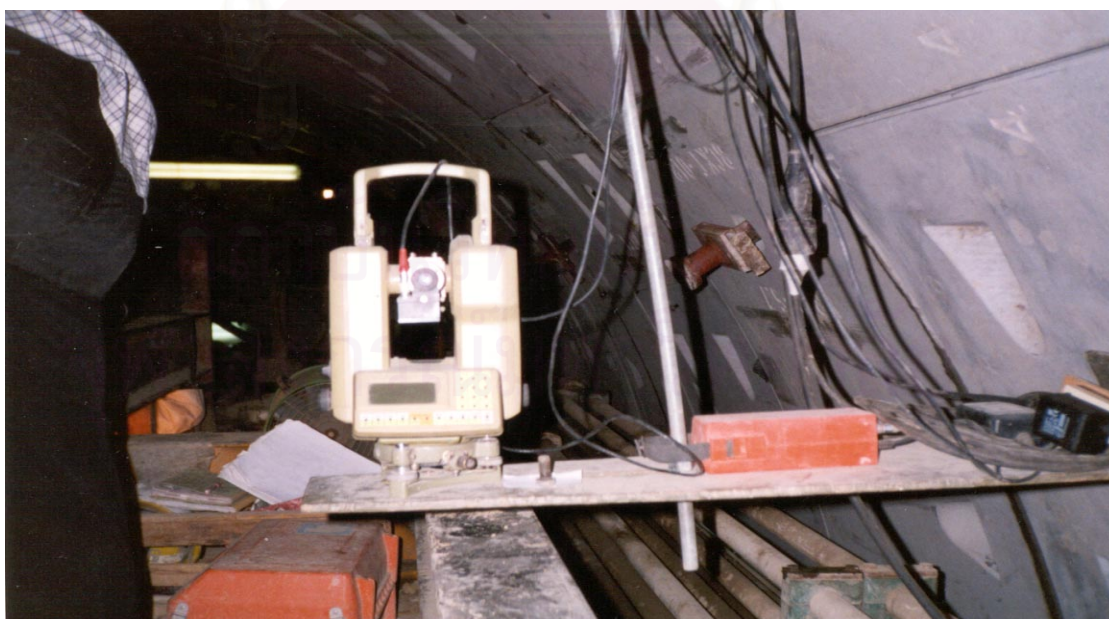
รูปที่ 2.11 แสดงวิธีการทำงานสำรวจ Laser Theodolite and Target Unit
