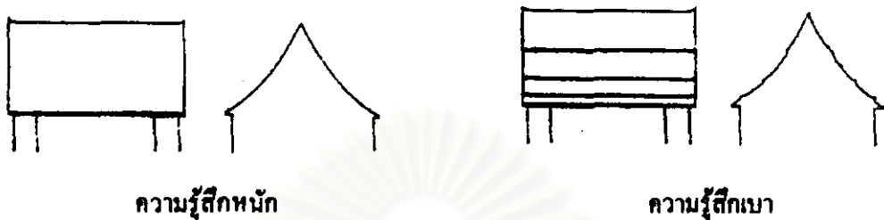
รูป 2.19 การเปรียบเทียบความรู้ตึกระหว่างการไม่ซ้อนชั้นหลังคา กับการซ้อนชั้นหลังคา (โชติ กัลยาณมิตร, 2539: 70)
