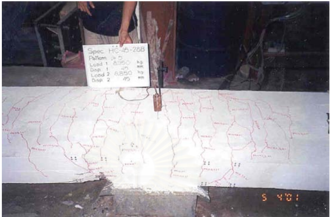
รูปที่ 3.40 ลักษณะรอยแตกร้าวที่รอยต่อเหนือแท่นรองรับ ของพื้นตัวอย่าง HC-45-28B
