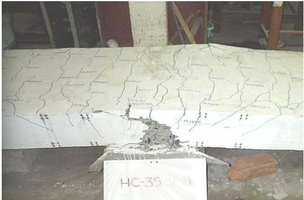
รูปที่ 3.38 ลักษณะรอยแตกร้าวที่รอยต่อเหนือแท่นรองรับ ของพื้นตัวอย่าง HC-35-98B
