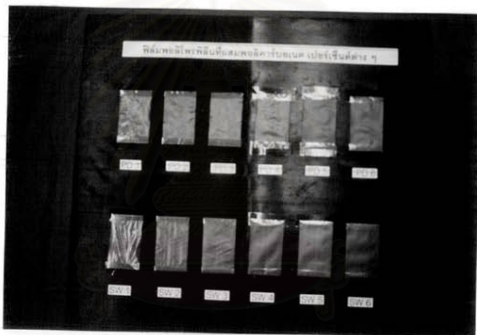
ภาพที่ 4.9 ฟิล์มที่ได้จากกระบวนการเป่าฟิล์มและกระบวนการหล่อฟิล์ม
