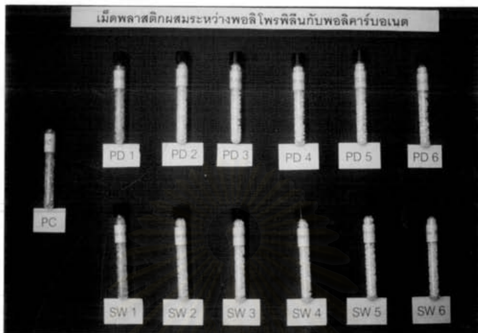
ภาพที่ 4.4 แสดงเม็ดพลาสติกผสมที่ได้จากกระบวนการอัดรีดแบบสกรูคู่
