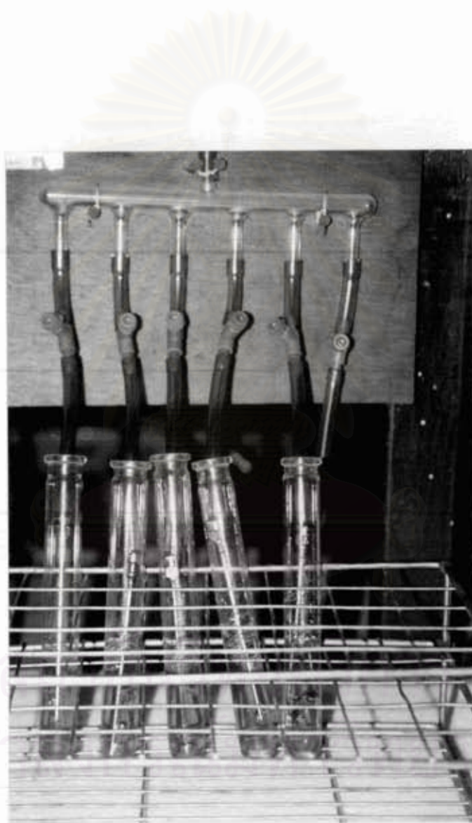
รูปที่ 3.20 การได้อากาศออกจากหลอดอาหารเลี้ยงเชื้อเหลวโดยใช้ก๊าซไนโตรเจน
