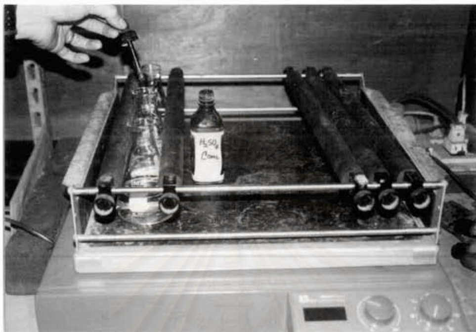
รูปที่ 3.10 การกำจัดซัลไฟด์ในน้ำเสียด้วยการปรับพีเอชและการเขย่าสร้างความปั่นป่วน
