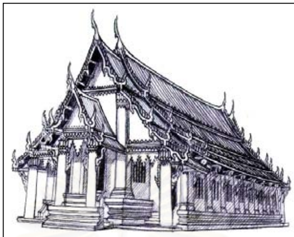
ภาพลายเส้นที่ 44 รูปทรงหลังคาอุปถัมภ์ด้านหลัง วัดกษัตราธิราช มีลักษณะหลังคาแบบมูขเด็จ (แบบมูขลดได้ชื่อ)
