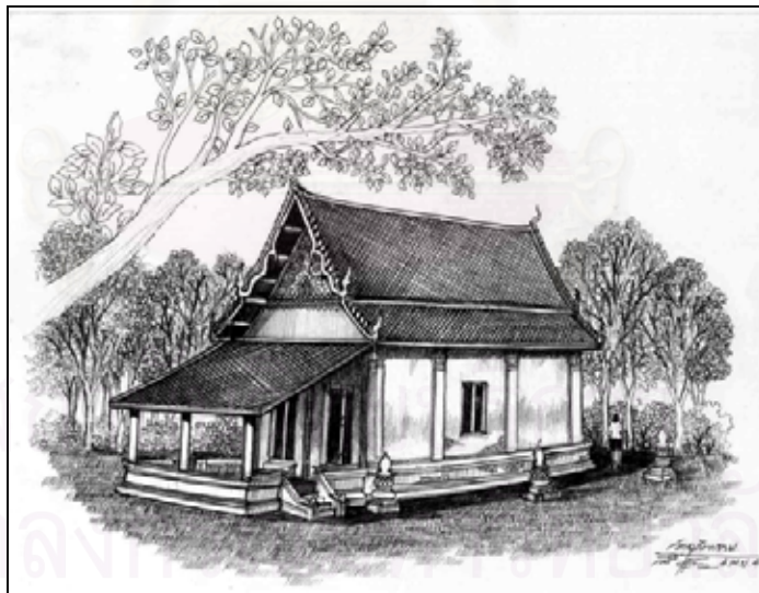
ภาพลายเส้นที่ 79 ลักษณะรูปทรงพระอุโบสถวัดดุสิตาราม มีลักษณะทางสถาปัตยกรรมแบบอย่างในยุคกลาง ซึ่งไม่มีประตูด้านหลังและทำช่องเปิดบานหน้าต่างน้อยซึ่งเริ่มตั้งแต่ 1 บาน จนถึง 3 บาน เป็นลักษณะพระอุโบสถขนาดเล็ก
