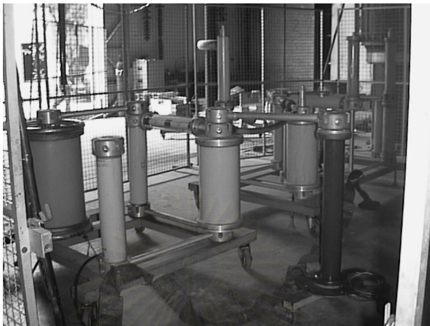
รูปที่ 4.15 การทดสอบสร้างแรงดันอิมพัลส์มาตรฐาน 1.2/50 \mu s
