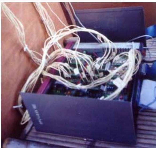
ภาพที่3-10 แสดงภาพเครื่องมือที่ใช้ในการเก็บข้อมูลทางอุณหภูมิ Data Logger System 200
