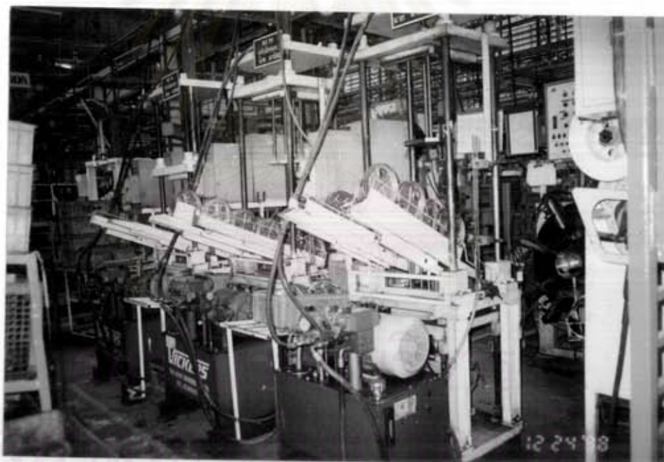
รูปที่ 4.10 ภาพรางสำหรับเดินชิ้นงาน (Shooter)ของสายการผลิตหม้อพักปลาย หลังจากทำการปรับปรุงการหยิบชิ้นงาน
