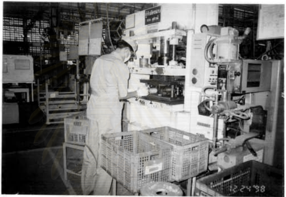
รูปที่ 4.7 ภาพการปรับปรุงสายการผลิตส่วนประกอบท่อ โดยจัดทำไคะเพื่อ พนักงาน สามารถเอื้อมในการหยิบชิ้นงานได้สะดวกขึ้น
