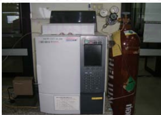
รูปที่ 3.4 เครื่องแก๊สโครมาโทกราฟี Shimadzu GC-2014
