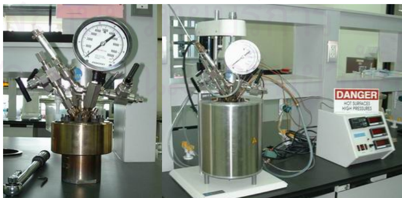
รูปที่ 3.1 เครื่องปฏิกรณ์ Parr Reactor Model 4843
