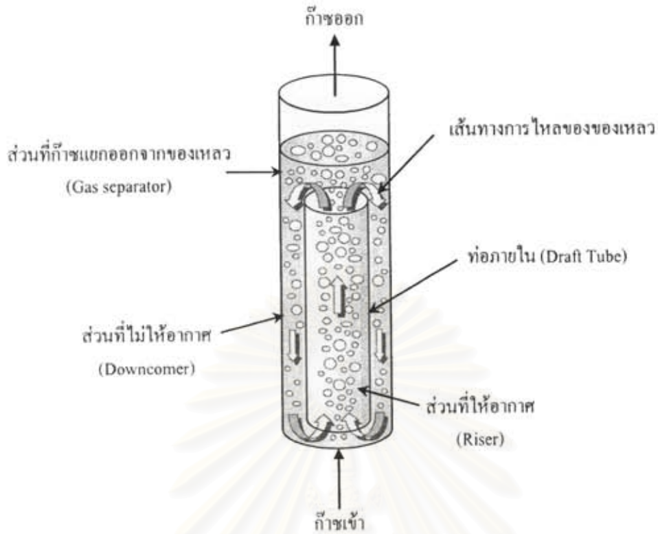
รูปที่ 1.1 ดังปฏิกรณ์เชิงแสงแบบอากาศยกที่ใช้ในการศึกษา
