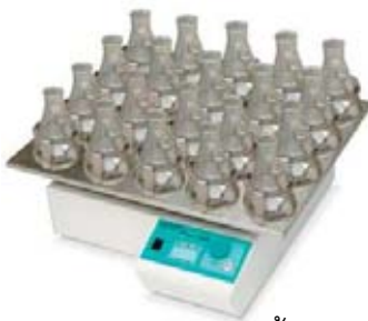
ภาพที่ 3 การให้อากาศในการเลี้ยงเส้นใย โดยอาศัยเครื่องเขย่า ที่มา: http://www.labnetlink.com/images/Orbit%201900%20full%20load.jpg
