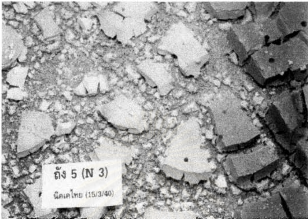
ภาพที่ 4.3 ผิวของกากสัดจ์จากโรงงานอะลูมิเนียมที่ยังคงความชื้นสูง แม้จะตากมาเป็นเวลาหลายวันแล้ว
