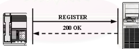
รูปที่ 5.9 การทดสอบการลงทะเบียนกับเครื่องแม่ข่าย
