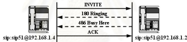
รูปที่ 6.14 การทดสอบการปฏิเสธการขอสร้างเซสชันระหว่างเครื่องโทรศัพท์ที่ได้พัฒนาขึ้น
