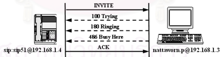
รูปที่ 6.13 การทดสอบการรองรับการปฏิเสธการขอสร้างเซสชันจากโปรแกรม SIP User Agent
