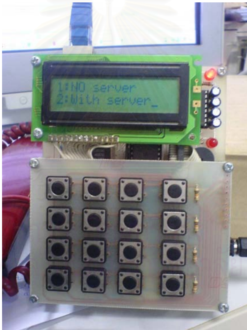
รูปที่ 6.1 เครื่องต้นแบบของโทรศัพท์อินเทอร์เน็ตที่พัฒนาขึ้น
