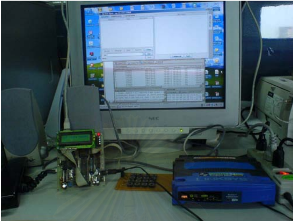
รูปที่ 6.2 การทดสอบเครื่องต้นแบบโทรศัพท์อินเทอร์เน็ตที่พัฒนาขึ้น
