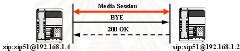
รูปที่ 6.17 การทดสอบการขอลิ้นสุดเซสชันระหว่างเครื่องโทรศัพท์ที่ได้พัฒนาขึ้น
