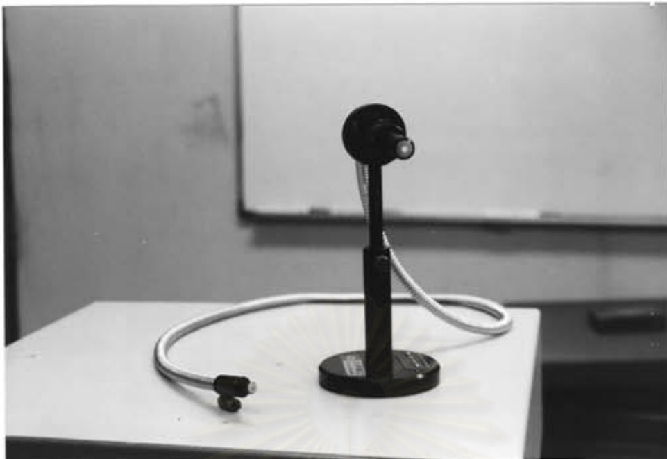
ข. เส้นใยแสงชนิดแก้วมัดรวมกัน (Glasses fiber optic bundles)
