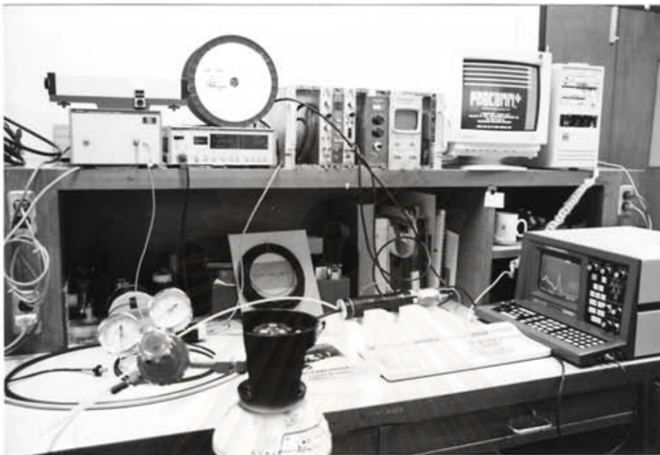
รูปที่ 3.14 ชุดอุปกรณ์ทดสอบการสูญเสียความเข้มประกายแสง
