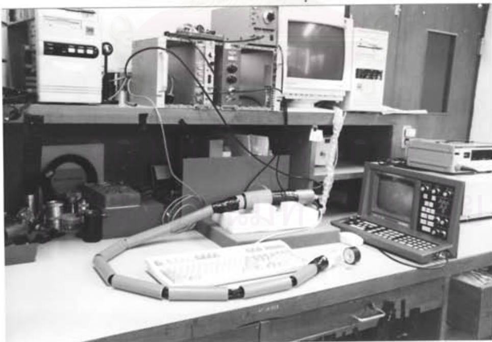
รูปที่ 3.15 ชุดอุปกรณ์ทดลองการส่งประกายแสงระยะไกลด้วยเส้นใยแสงแบบมัด
