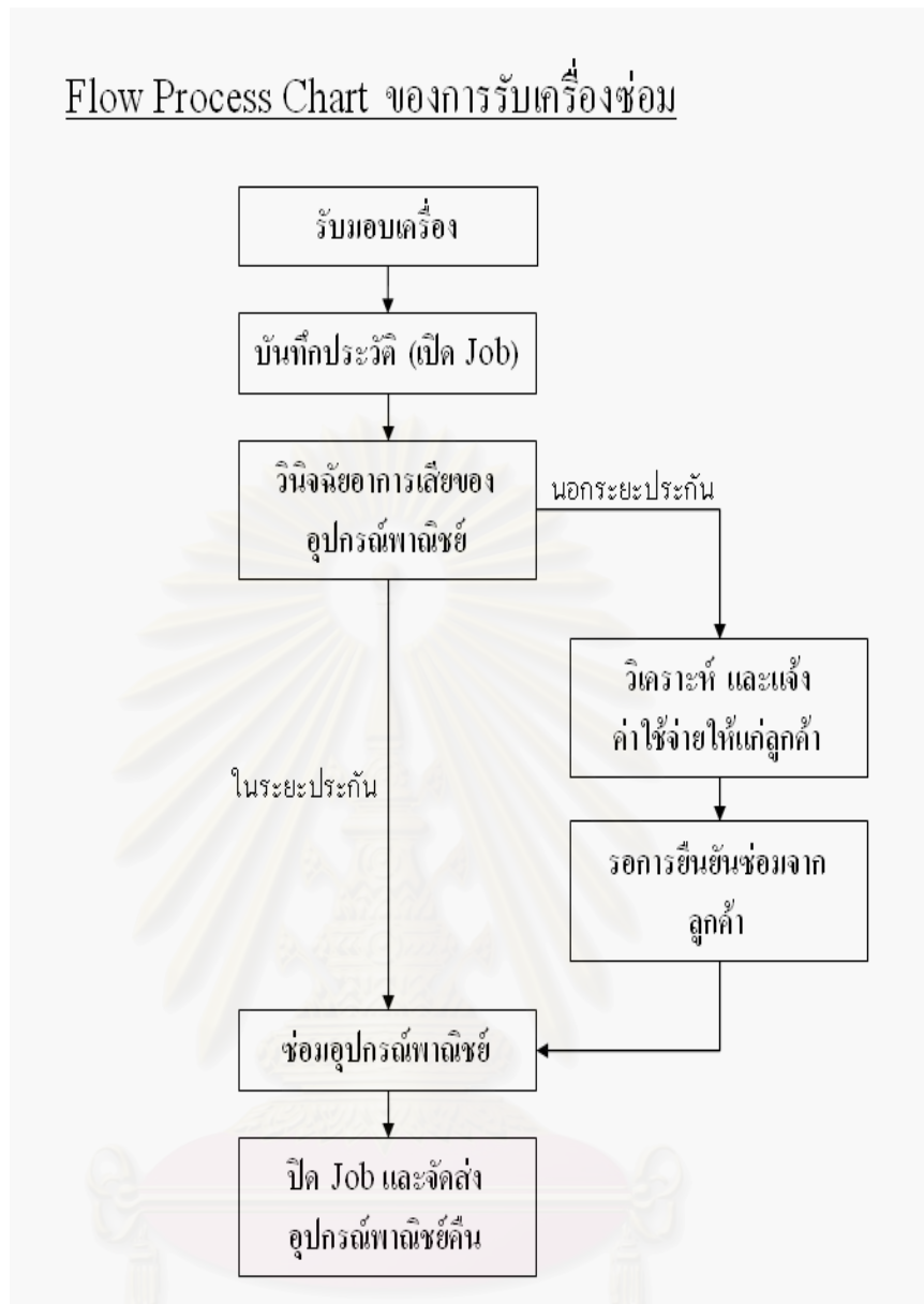
รูปที่ 3.4 Flow Process Chart ของการรับเครื่องซ่อม
