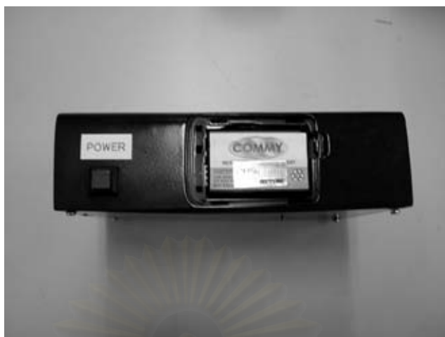
รูปที่ 3.3 แบตเตอรี่โทรศัพท์มือถือไฟตรง 3.6 V ที่ใช้เป็นแหล่งจ่ายพลังงานในระบบวัด
