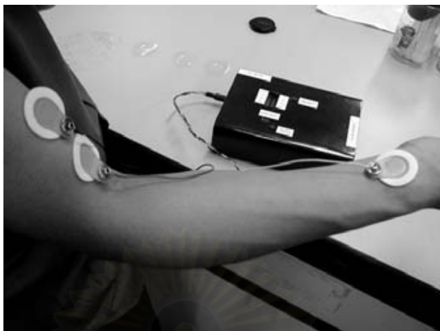
รูปที่ 5.24 การทดสอบวัดสัญญาณกล้ามเนื้อจริงจากคนปกติที่ตำแหน่งไบเซ็ป (Biceps)
