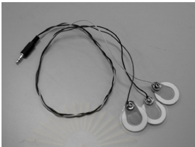
รูปที่ 3.13 อิเล็กทรอนิกส์แบบผิวสัมผัสที่ใช้ในการวัดสัญญาณกล้ามเนื้อ
