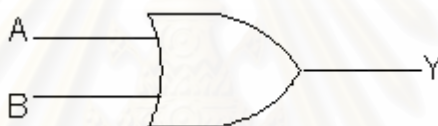
รูปที่ 3.3 สัญลักษณ์แทนอุปกรณ์เกตออร์ (OR)
