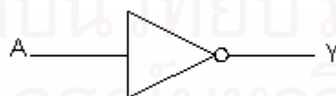
รูปที่ 3.7 สัญลักษณ์แทนอุปกรณ์เกตอินเวอร์เตอร์ (NOT)
