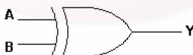
รูปที่ 3.5 สัญลักษณ์แทนอุปกรณ์เกตเอ็กซ์คลูซีฟออร์ (XOR)
