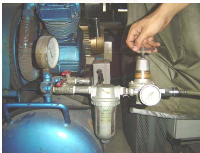
รูปที่ 4.44 แสดงวิธีการปรับวาล์วควบคุมความดัน
