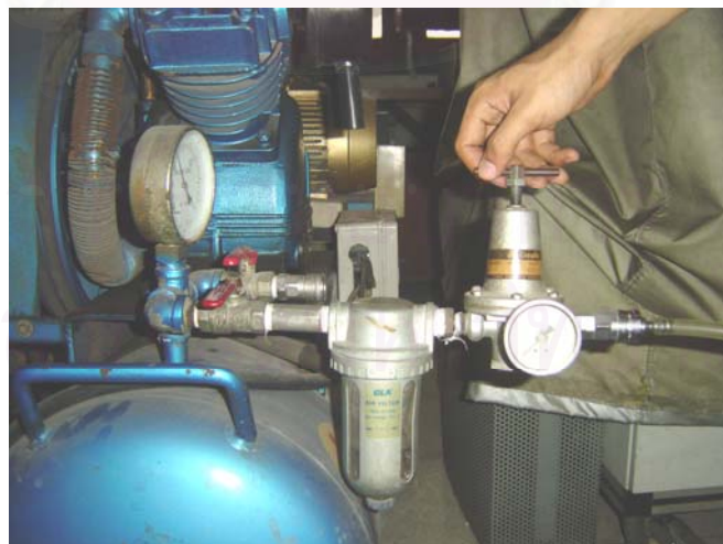
รูปที่ 4.15 แสดงวิธีการปรับวาล์วควบคุมความดัน
