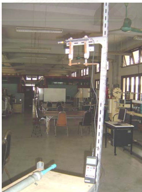
รูปที่ 4.31 แสดงวิธีการวัดหาปริมาณการรั่วซึมโดยใช้วิธีวัดอัตราไหลของลำการไหล
