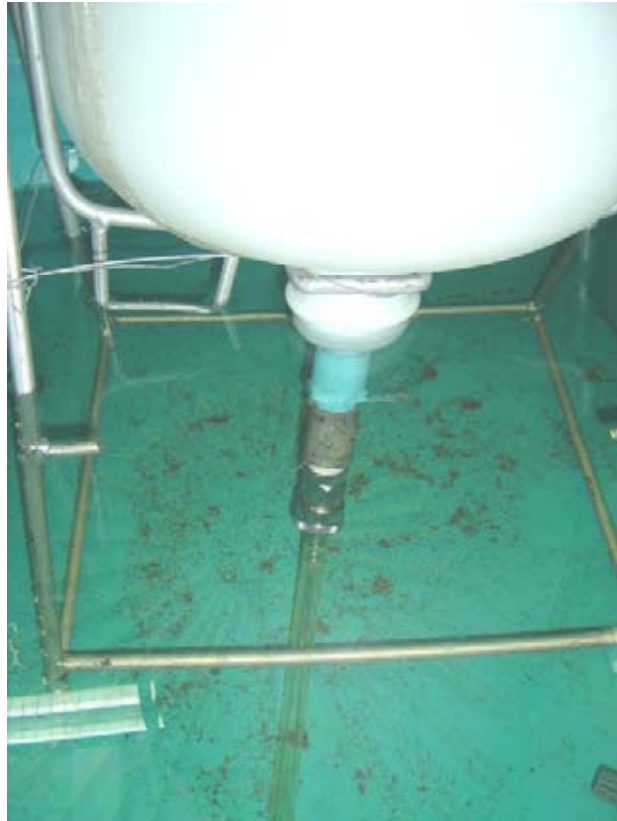
รูปที่ 4.14 แสดงวิธีการนำส่วนที่เกิดการรั่วซึมใส่เข้าไปในกระบอกตวง
