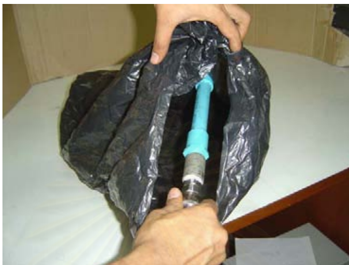
รูปที่ 4.23 แสดงวิธีนำถุงไปครอบตำแหน่งที่เกิดการรั่วซึม
