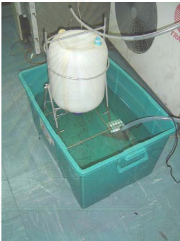
รูปที่ 4.11 แสดงวิธีการนำกระบอกตวงพร้อมขาตั้งใส่ในถังที่บรรจุน้ำ
