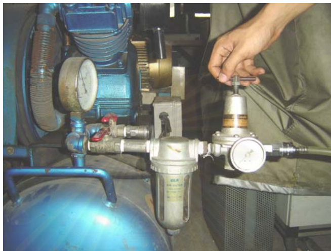
รูปที่ 4.34 แสดงวิธีการปรับวาล์วควบคุมความดัน
