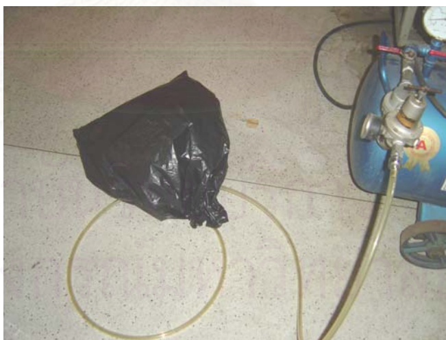
รูปที่ 4.20 แสดงวิธีการวัดหาปริมาณการรั่วซึมโดยใช้ถุงครอบ
