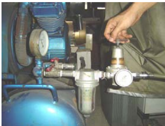
รูปที่ 4.52 แสดงวิธีการปรับวาล์วควบคุมความดัน
