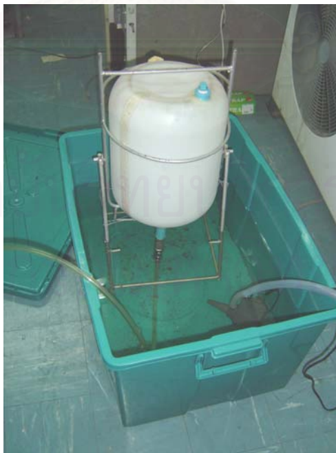
รูปที่ 4.10 แสดงวิธีการวัดหาปริมาณการรั่วซึมโดยใช้หลักการแทนที่น้ำ
