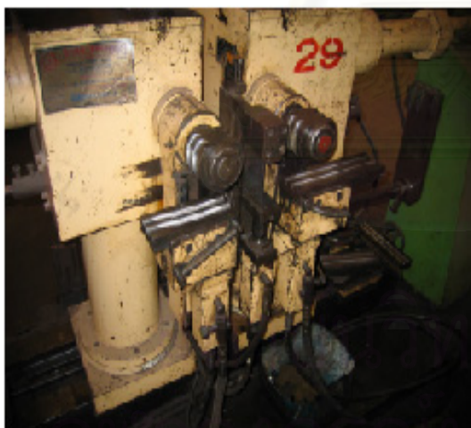
รูปที่ 5.3 เครื่องจักรที่ใช้ตัดท่อเหล็ก และผลิตภัณฑ์สำเร็จจากเครื่องตัดท่อเหล็ก
