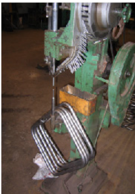
รูปที่ 5.4 รูปเครื่องเชื่อมแบบหมุดย้ำและผลิตภัณฑ์สำเร็จจากเครื่องเชื่อมแบบหมุดย้ำ
