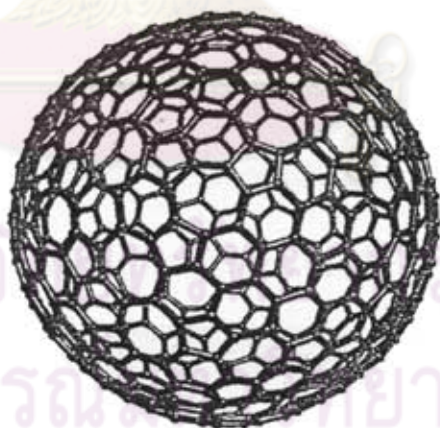
รูปที่ 3.5 แบบจำลองโครงสร้างอนุภาคคาร์บอนนาโนรูปหัวหอมของ Terrones
