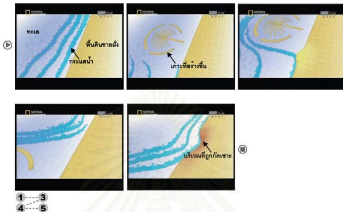
ภาพที่ 4.7 ภาพกราฟิกจำลองการกัดเซาะของกระแสน้ำที่เปลี่ยนทิศทาง
