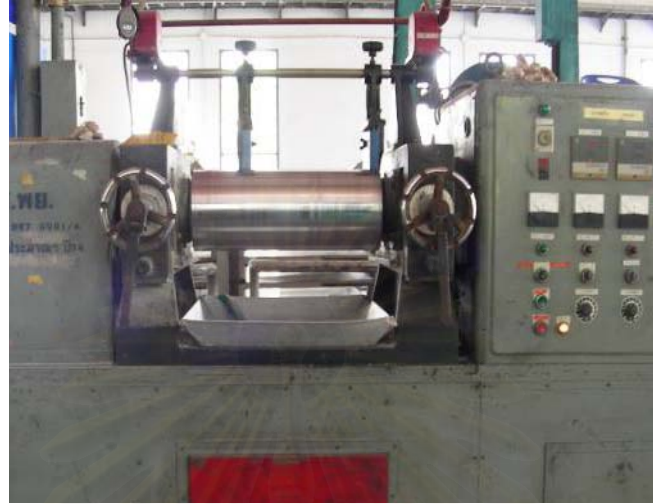
ภาพที่ 6 แสดงเครื่องบดผสมยางระบบเปิด (open mill mixer)
