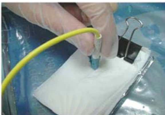
รูปที่ 5.1 การทำความสะอาดหน้าเลนส์หัวเลี้ยวด้วยกระดาษทำความสะอาดหน้าเลนส์
