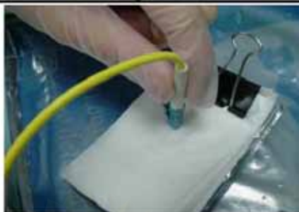
Figure 7: Lens cleaning using wiper paper and lens cleaning solvent รูปที่ 7: การทำความสะอาดหน้าเลนส์ของหัวเสียบโดยใช้กระดาษเช็ดร่วมกับน้ำยาทำความสะอาดหน้าเลนส์
