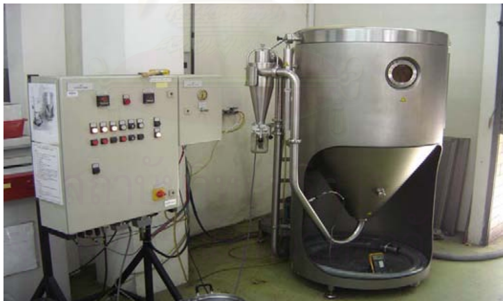
รูปที่ 3.4 เครื่องอบแห้งแบบพ่นฝอย (Spray Dryer)
