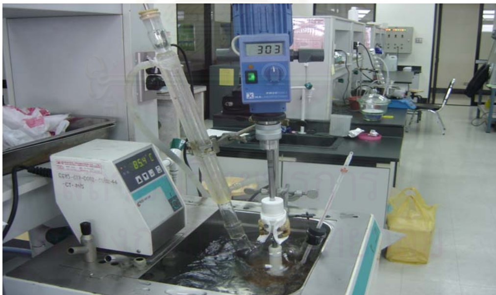
รูปที่ 3.2 เครื่องสกัดแบบแบตช์ระดับปฏิบัติการ
