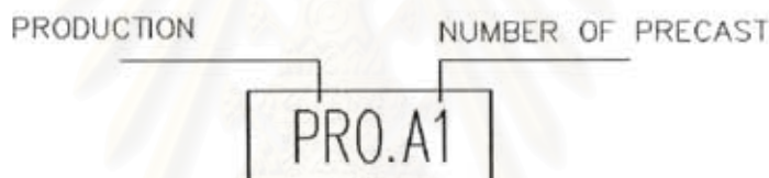
ภาพที่ 5.47 แสดงความหมายของ CODE แผ่นผนัง ค.ส.ล. สำเร็จรูป
