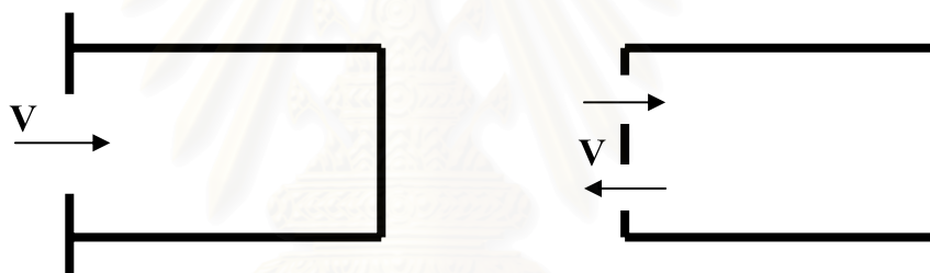
รูปที่ 2.3 รูปแบบการไหลเวียนของกระแสลมแบบการระบายอากาศด้านเดียว (single-sided ventilation) (Allard, 1998)
