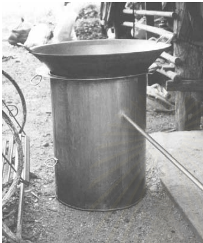
๒ ชุดอุปกรณ์ต้มกลั่นสุราที่ทำจาก สแตนเลส
