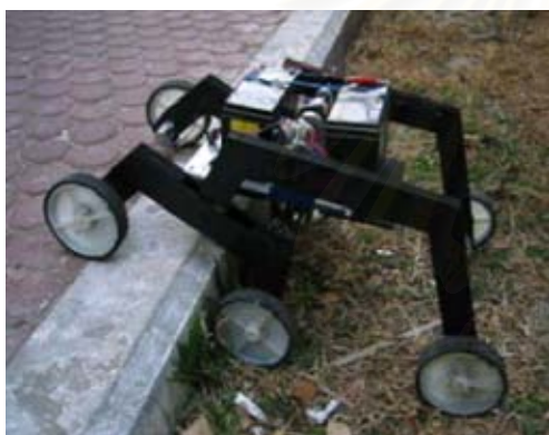
รูปที่ 3.9 หุ่นยนต์ต้นแบบเคลื่อนที่ผ่านอุปสรรคที่มีลักษณะเป็นขั้น และทางลาดชัน
