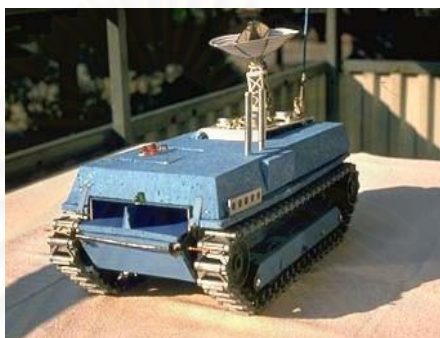
รูปที่ 2.3 [1] หุ่นยนต์ K1, การเคลื่อนที่โดยอาศัยล้อและสายพาน
