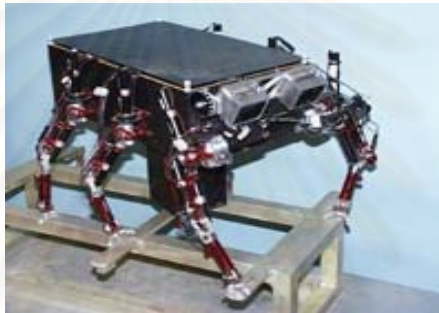
รูปที่ 2.1 [1] หุ่นยนต์Lemur, การเคลื่อนที่เลียนแบบแมลง
