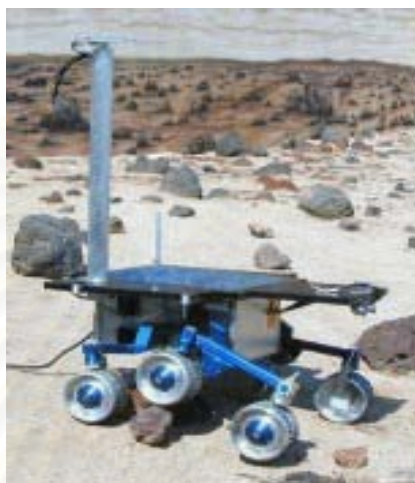
รูปที่ 2.7 [3] หุ่นยนต์ Fido, การเคลื่อนที่โดยใช้ระบบช่วงล่างแบบ Rocker-Bogie
