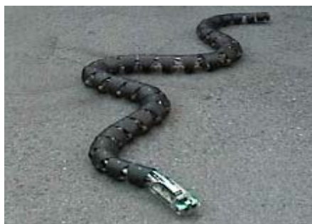
รูปที่ 2.2 [1] หุ่นยนต์ S5, การเคลื่อนที่เลียนแบบงู
