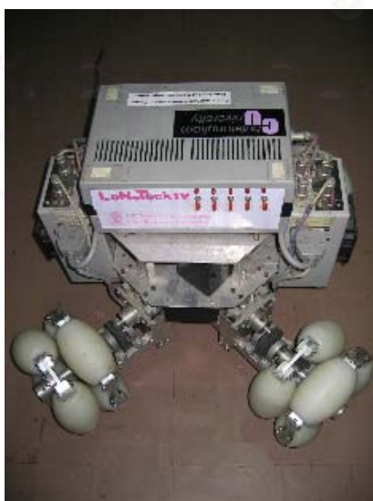
รูปที่ 2.4 หุ่นยนต์ Lonotech 4, การเคลื่อนที่โดยใช้ล้อ Omni-directional
