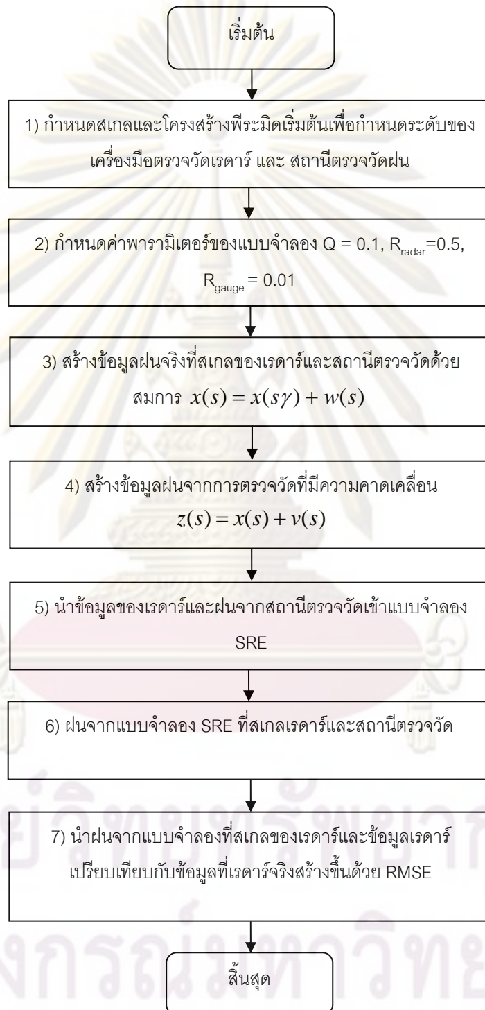
รูปที่ 6 -1 ขั้นตอนการทดสอบแบบจำลอง SRE จากข้อมูลสังเคราะห์
