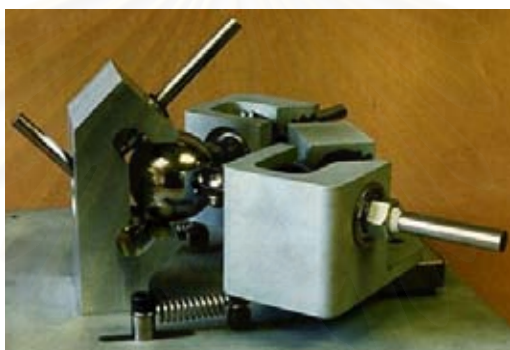
รูปที่ 2.7 อุปกรณ์ปรับเปลี่ยนอัตราทดแบบต่อเนื่องชนิดทรงกลม ที่มา [4]
