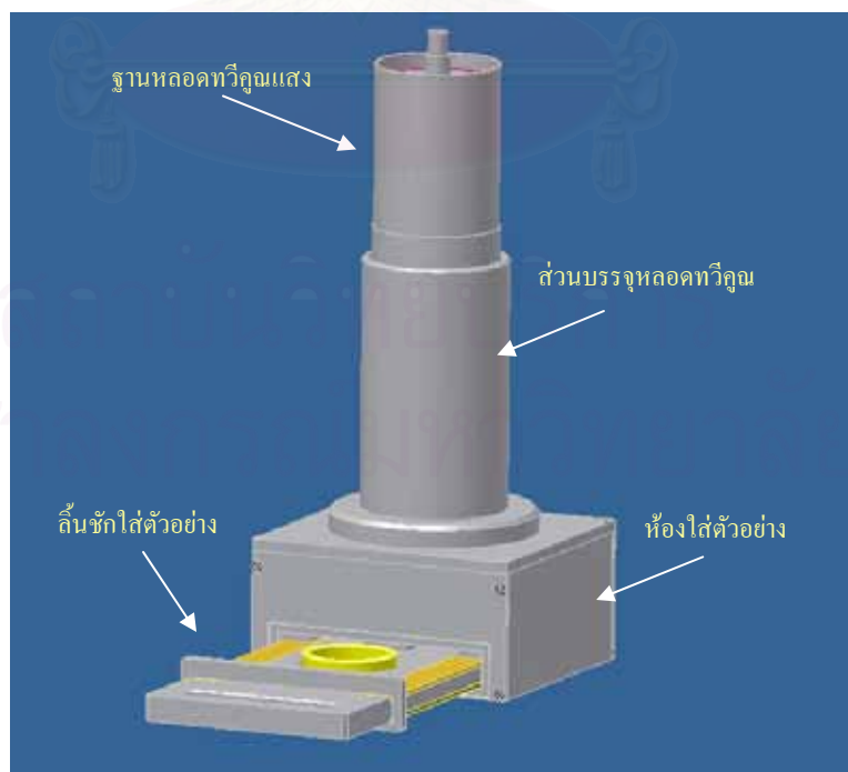
รูปที่ 3.2 โครงสร้างของห้องกระตุ้นตัวอย่างเครื่องเทศและวัดโฟตอนเรืองแสง
