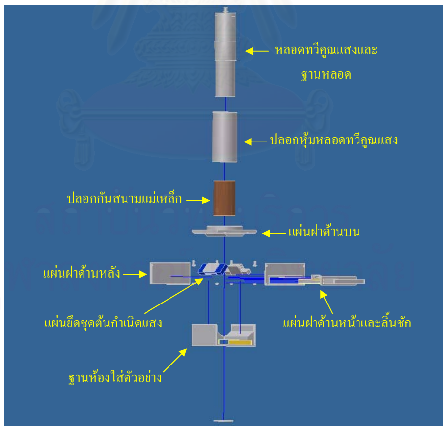
รูปที่ 3.4 แบบแยกส่วนของห้องกระตุ้นตัวอย่างเครื่องเทศและวัดโฟตอนเรืองแสง
