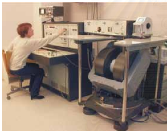
รูปที่ 2.8 เครื่อง ESR และตัวอย่างสเปกตรัม
