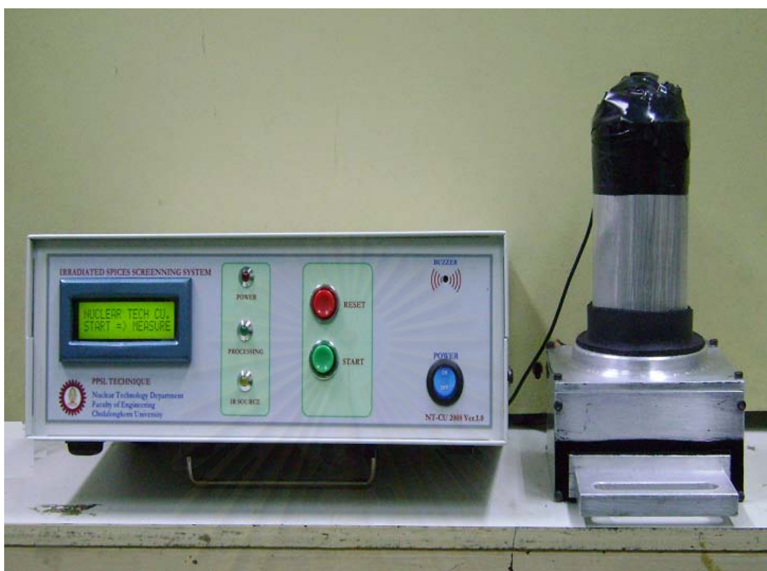
รูปที่ 3.16 ภาพระบบตรวจสอบเครื่องเทศผ่านการฉายรังสีที่พัฒนาขึ้น
