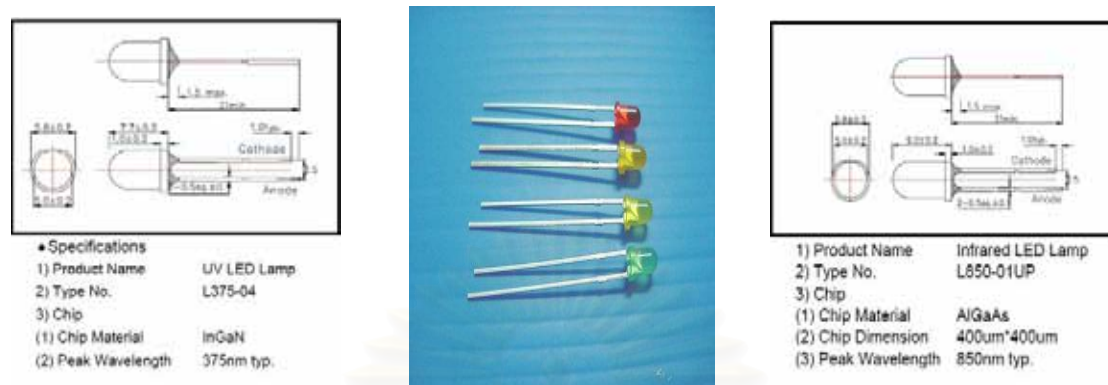
รูปที่ 2.26 ไดโอดเปล่งแสงที่ให้ ความยาวคลื่นแสงในย่านต่างๆ
