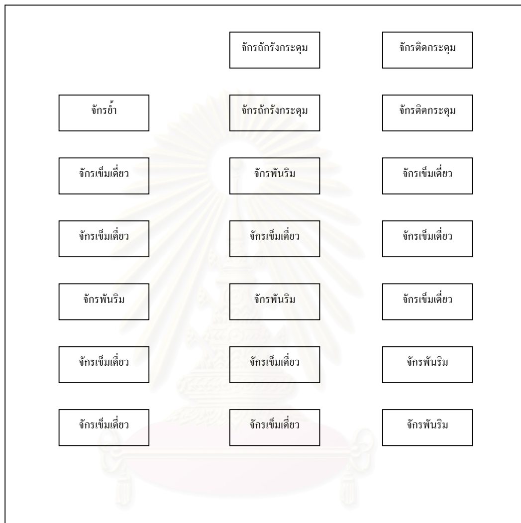
ภาพที่ 2.21 การจัดวางเครื่องจักรตามขั้นตอนการเย็บ
