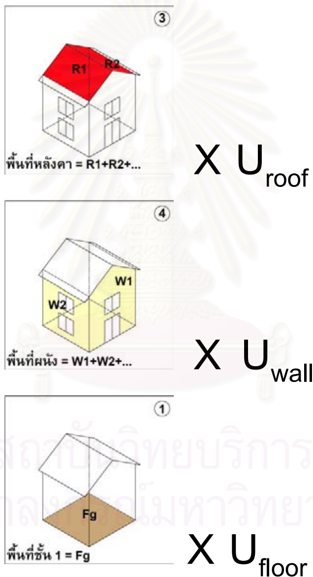
ภาพ 5-7 แสดงคำนวณหา u เฉลี่ยของพื้นที่ผิวเปลือกนอกของอาคาร
