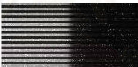
รูปที่ 4.2 แสดงภาพบริเวณรอยต่อระหว่างแผ่นตะกั่วกับอากาศเมื่อฉายด้วยรังสีเอกซ์
