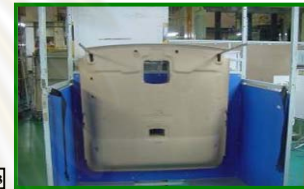
13 นำชิ้นงานวางบน RACK ในกระบวนการให้พนักงานส่งแก่ RACK จะมีป้ายออกรายละเอียดของชิ้นงานนั้นๆแขวนที่ RACK
