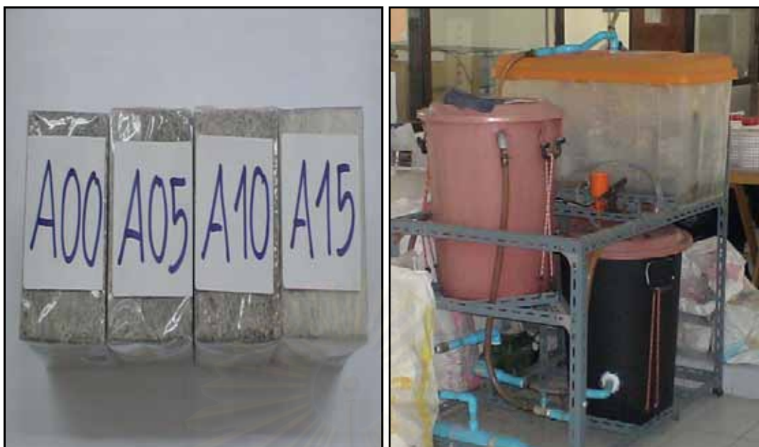
รูปที่ 3.1 ตัวอย่างก้อนแข็งที่อายุบ่ม 28 วันและอุปกรณ์ในการบ่มก้อนตัวอย่าง
