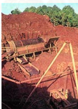
ภาพที่ 3.4 แสดงการขุดพลอยโดยใช้รดตัดดิน
