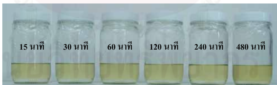
รูปที่ 4.4 แสดงลักษณะทางกายภาพของชั้นสารละลายกรดกำมะถันและชั้นน้ำมันที่เวลาในการกวนสารต่างๆ
